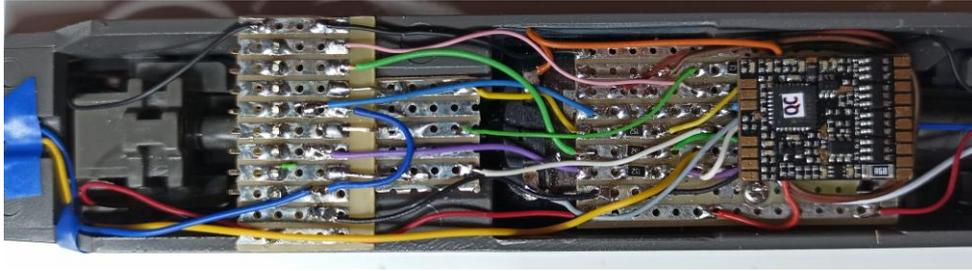
Los cables que van a los bogies (negro y rojo) se sueldan a las tiras laterales de las dos placas y los procedentes de la bombilla se conectan a las tiras del positivo común a F0d y F0t. Como se puede ver en la imagen el descodificador ya está montado y oculta parte de las conexiones de la placa adaptadora a la placa del sistema. La placa intermedia es una pegada por debajo de la de los conectores para evitar que ésta se mueva, y podría haber sido perfectamente parte de la misma y formar una T.
