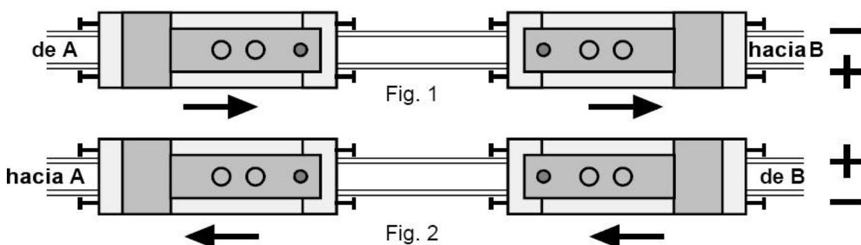
Como podemos ver en analógico el sentido de marcha en el carril derecho es positivo en la figura 1 y la locomotora se mueve de A hacia B, independientemente de que la chimenea esté en la parte delantera o no. En la figura dos cuando el polo positivo está en el carril izquierdo en sentido es contrario al anterior, de B hacia A.
