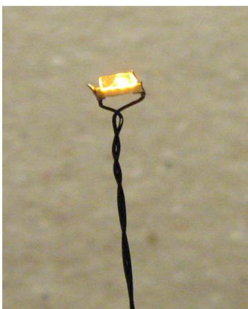
En los contactos de los leds se sueldan cables esmaltados de escaso grosor (0,15 mm) de color negro. El problema para realizar este tipo de actuación es que se tiene que saber soldar material SMD y utilizar gafas graduadas o lupas para poder ver lo que tenemos entre manos. El soldador tendría que ser de 17W con punta muy fina mejor que otro superior, que por su potencia nos puede quemar el led.
