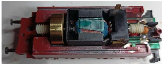
De momento las dos láminas para soldar los cables de las escobillas están hacia arriba.
