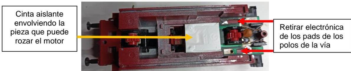
Hay una pieza de iluminación trasera que se debe desoldar de esta pieza y dejar todo como se puede ver en la foto. Luego soldaremos en la placa los dos cables rojo y negro de la vía en los pads
