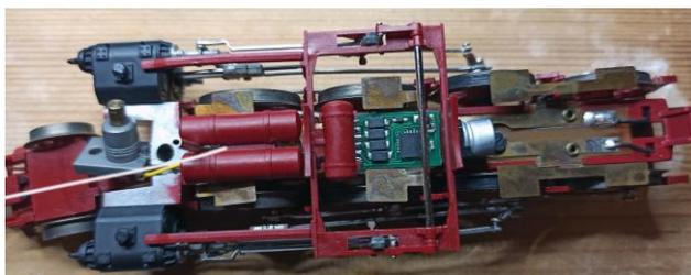
Así podemos ver que el cable amarillo de la función irá al fumígeno, mientras el blanco va al tubo metálico que sobresale entre los dos calderines.
