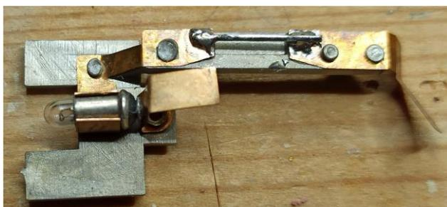
En este caso he dejado la misma bombilla ya que al no utilizar el cable azul (positivo común), luce de forma similar a la del tender. La pieza aludida se debe poner en la ranura que tiene la caldera, y debemos tener en consideración que la parte trasera de la pieza no debe doblarse para que luego toque en la pieza metálica que hace de conductor del cable blanco o luz delantera.
