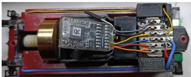
Los cables sobrantes de funciones se pueden desoldar del descodificador, cortar y proteger (como es el caso de la foto). Aquí he desplegado el descodificador sobre el motor porque luego los cables van plegados sobre sí mismos y el descodificador quedará sobre la placa que he realizado. Como se puede ver en la foto por orden desde arriba hacia abajo están los cables, gris, negro, amarillo, azul, rojo y naranja, que implican las seis conexiones que llevará el ténder.
