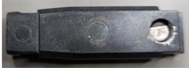
En la foto se puede ver como queda el condensador incluido en el agujero y visto desde arriba. Luego por debajo aislamos el contrapeso con cinta aislante y hacemos pasar los cables desde el condensador al descodificador. El conjunto antes de poner la carrocería sobre el chasis queda como se puede ver en la foto.
