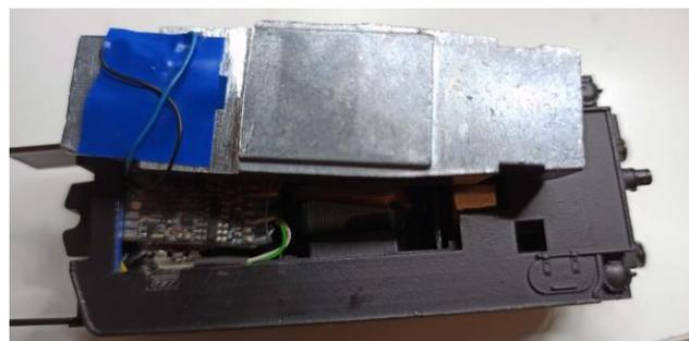
En este caso es la opción con el condensador incluido en el contrapeso. Una vez puesto todo en su sitio, y si fuera necesario probado en la vía de programación, ya podemos cerrar el tender y atornillar los dos tornillos de cabeza plana que hay en los dos enganches.
