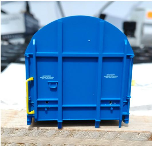
En el testero, entre las dos piezas que conforman los nervios hice un agujero con una broca de 0,8, suficiente para que pasen dos cables esmaltados.
