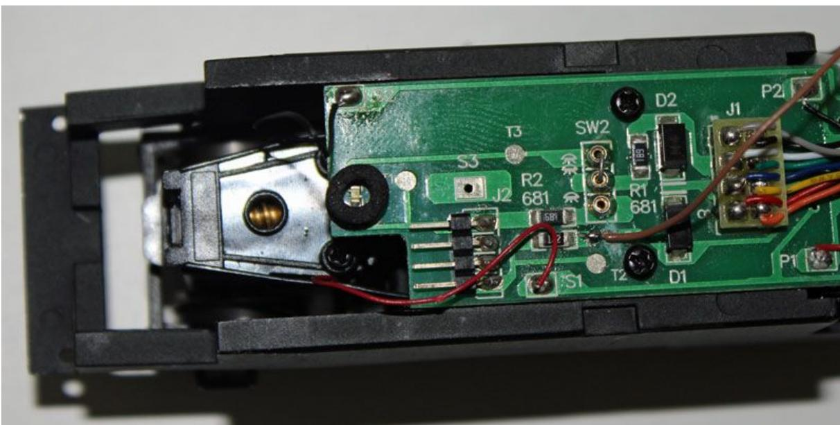
2º sueldo cada cable a cada una de las pistas de los leds rojos (recordar que tiene que hacerse antes de la resistencia de carga del led, esto evitará que se nos quemé).
