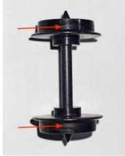
En esta otra foto tenemos una rueda con un perfil de rodadura desgastado (como se puede ver en las marcas) y el desgaste produce una leve hendidura en la llanta de la rueda que puede dar el mismo tipo de problema de cortocircuito.
