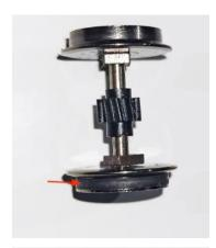
En la parte izquierda tenemos un eje de locomotora con un aro de adherencia (aparentemente en buen estado), como se muestra con la flecha roja. Un aro de adherencia inexistente (puede darse el caso), desgastado o que no tiene el alto suficiente puede hacer que por ese lado de la rueda se produzca un cortocircuito entre la pestaña interior de la rueda y el resalte exterior de la misma y que sirve para aguantar el aro de adherencia.
