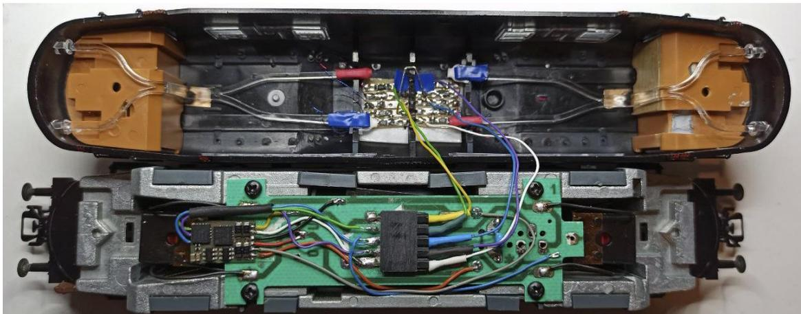
Conectadas ya las funciones se puede cerrar la carrocería, teniendo en cuenta que el cable verde y amarillo deben quedar por la parte exterior del conector y los otros tres en la parte interior del difusor del lado derecho. Para ello lo mejor el cerrar la carrocería en forma de sándwich y ajustarla.
