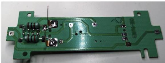
En la parte inferior quitaremos las dos resistencias, en su lugar pueden ir uno o dos pequeños condensadores de 100  $\mu$ F que no molestarán el cardán del motor al bogie. En ese extremo no tenemos volante de inercia.
