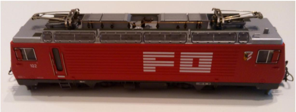
En la preparación he realizado vueltas en analógico a la locomotora para ver los fallos que comportaba su funcionamiento, resultando que a velocidades bajas un motor tendía a arrastrar al otro haciendo chirriar las ruedas incluso en recta, y en velocidades altas uno de los motores hacía un ruido diferente, señal de que iba forzado.
