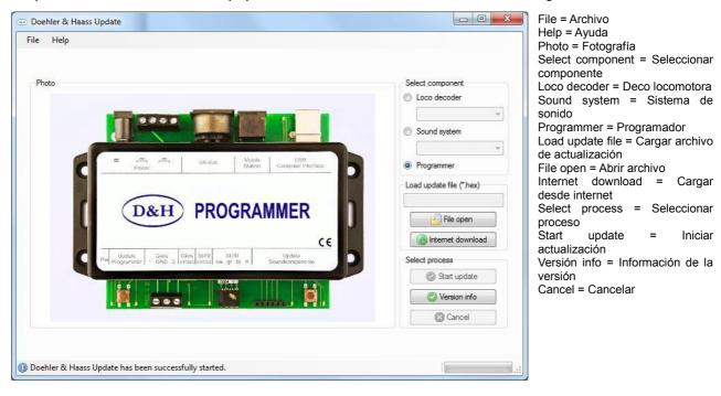
Cuando el archivo se haya cargado el programador puede ser conmutado mediante el botón pulsador "modo de actualización operativo" T1, por ejemplo 1.5 segundos. El proceso de actualización puede iniciarse mediante Starting Update y esperar alrededor de 3 segundos.
