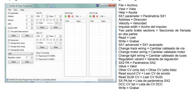
El descodificador puede ser programado en los formatos de los sistemas SX1 / SX2 / DCC.
