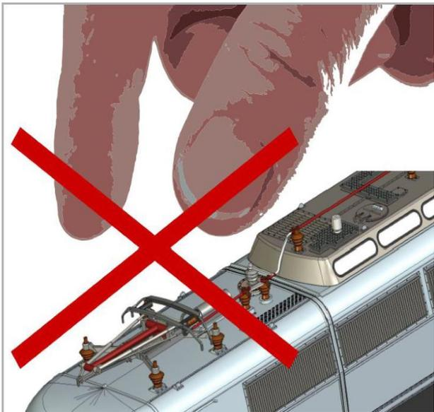
**Figura 1: No levantar el pantógrafo con la mano**
