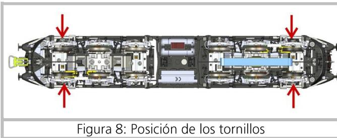
Figura 8: Posición de los tornillos
