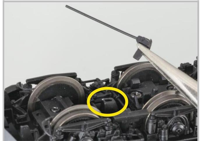
Figura 9: Retirar la barra de tracción
