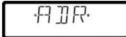
Se introduce la nueva dirección en el descodificador. Aparecerá la letra "P" en la línea inferior mientras dure el proceso de grabación.
