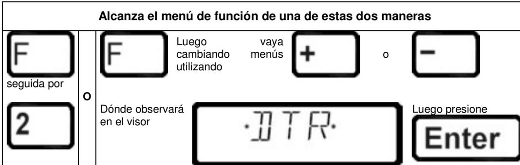
El LH100 le permite asignar dos locomotoras para funcionar juntas como una doble tracción, y luego controlarlas como si se tratara de una sola locomotora.
