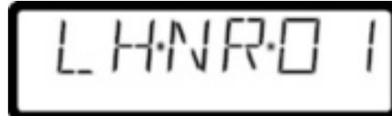
Después de alrededor de 1 segundo aparece la dirección de la locomotora que ha conducido por última vez. Durante la primera puesta en marcha del aparato se muestra la dirección 03.
