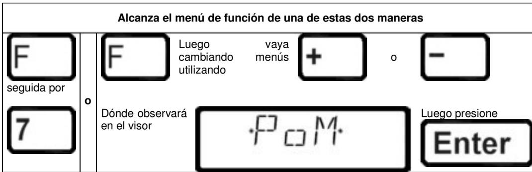
Programar durante la marcha es interesante principalmente para descodificadores de locomotora, ya que con PoM la configuración del descodificador puede ser cambiada en la vía normal "operativa". Esto significa que la locomotora puede estar en cualquier parte del circuito. Para cambiar una configuración utilizando PoM el descodificador no tiene que ponerse en la vía de programación.
